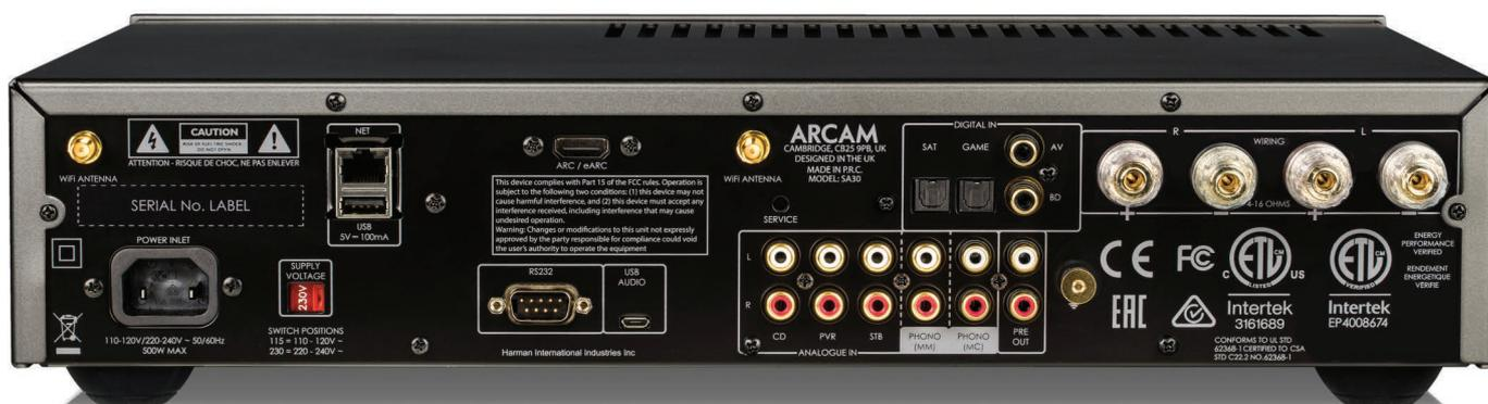
Curiosa la presenza di ingresso separato per giradischi MM e MC, il che dà anche la possibilità di collegare simultaneamente due testine, visto che gli ingressi sono separati. Notare i robusti binding-post in grado di serrare qualsiasi tipo di terminazione.
